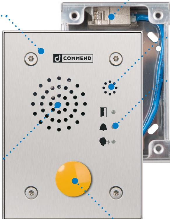
Gehäuse mit integriertem RJ45-Adapter und Verbindungskabel sorgt für einfache Installation und benötigt keine zusätzlichen Komponenten.
