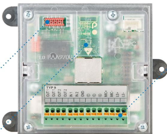
Пружинные зажимы для электрического соединения без инструментов.
