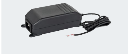
PA60W24V - 60 Watt Tischnetzteil, Eingang: 100-240 VAC mit IEC-60320-C14 Anschluss, Ausgang: 24 VDC mit offenen Kabelenden - Kabellänge: 1,5 m (IEC-Kabel KAB-C13 nicht enthalten). Achtung: nicht konform mit UL 62368-1 (cULus)
