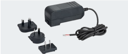
PA30W24V-CA - 30 Watt-Steckernetzteil, Eingang: 100-240 VAC mit austauschbaren Steckern (AU/UK/US), Ausgang: 24 VDC mit offenen Kabelenden. Kabellänge: 1,5 m. Achtung: nicht konform mit UL 62368-1 (cULus)
