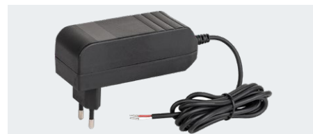
PA30W24V-EU - Alimentation électrique enfichable 30 W, entrée : 100-240 VCA avec connecteur EU solide, sortie : 24 VCC avec extrémités de câble nues. Longueur de câble : 1,5 m. Attention : non conforme à UL 62368-1 (cULus)
