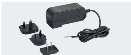
PA30W24V-CA - Alimentation électrique enfichable 30 W, entrée : 100-240 VCA avec connecteur interchangeables (AU/UK/US), sortie : 24 VCC avec extrémités de câble nues. Longueur de câble : 1,5 m. Attention : non conforme à UL 62368-1 (cULus)
