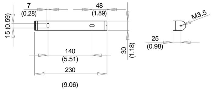
**Примечание:** Требуемый момент затягивания для двух установочных винтов составляет 0,3 Нм.
